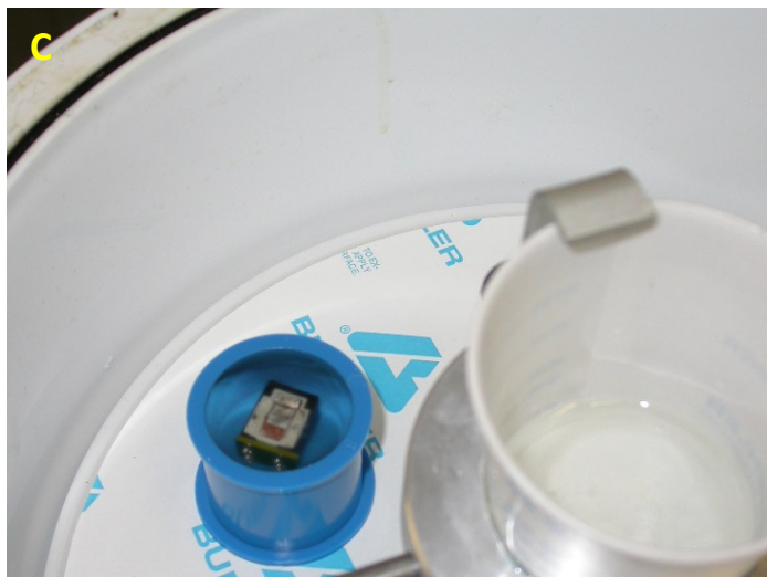
図 A: 真空含浸装置 カスト N1000
